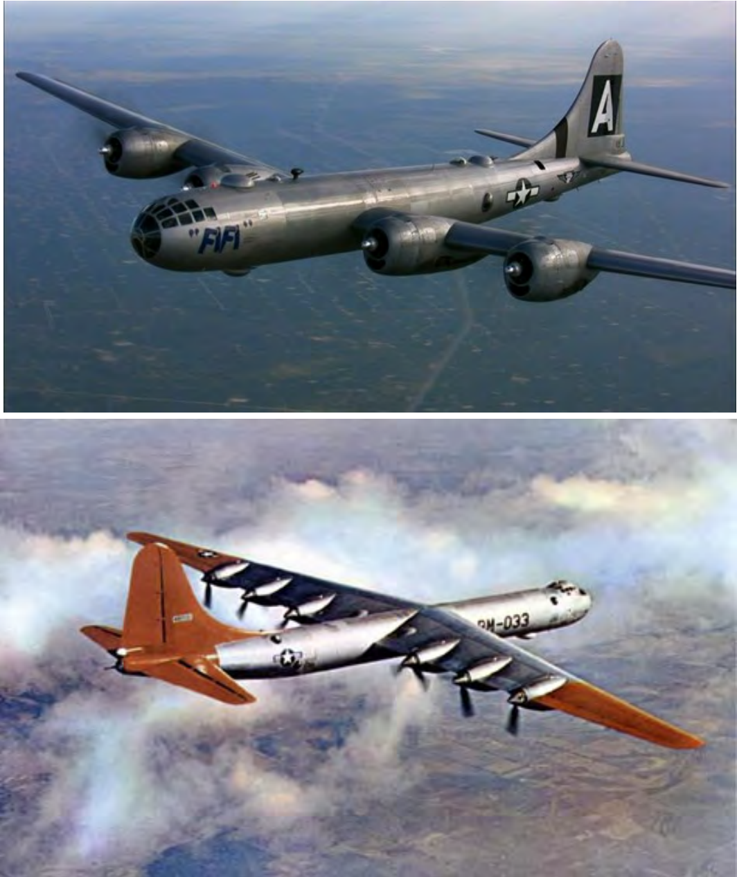
Figure 6.31: Configurazione con eliche traenti (Boeing B-29, in alto), e spingenti (Convair B-36, in basso), da [138, 139].
