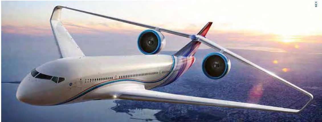
Figure 8.7: Configurazione ad ala di Prandtl, da [149].
