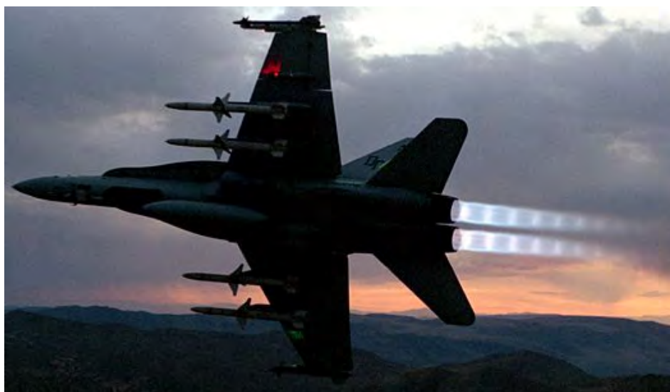
Figure 6.19: Urti all'uscita dell'ugello sottoespanso di un F-18, da [132].
