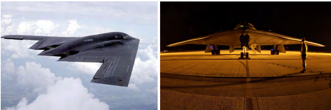
Figure 3.25: Bombardiere stealth Northrop Grumman B-2 Spirit. A sinistra, notare i motori entro le ali, e l’assenza di impennaggi; a destra, la prevalenza di angoli ottusi, da [91, 92].
