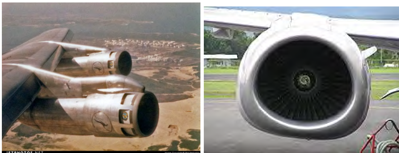
Figure 6.13: Slats (a sinistra) adottate dal motore di un Boeing 707; (a destra) presa d'aria 'hamsterized' di un Boeing 737 con motori CFM56, da [127, 128].
