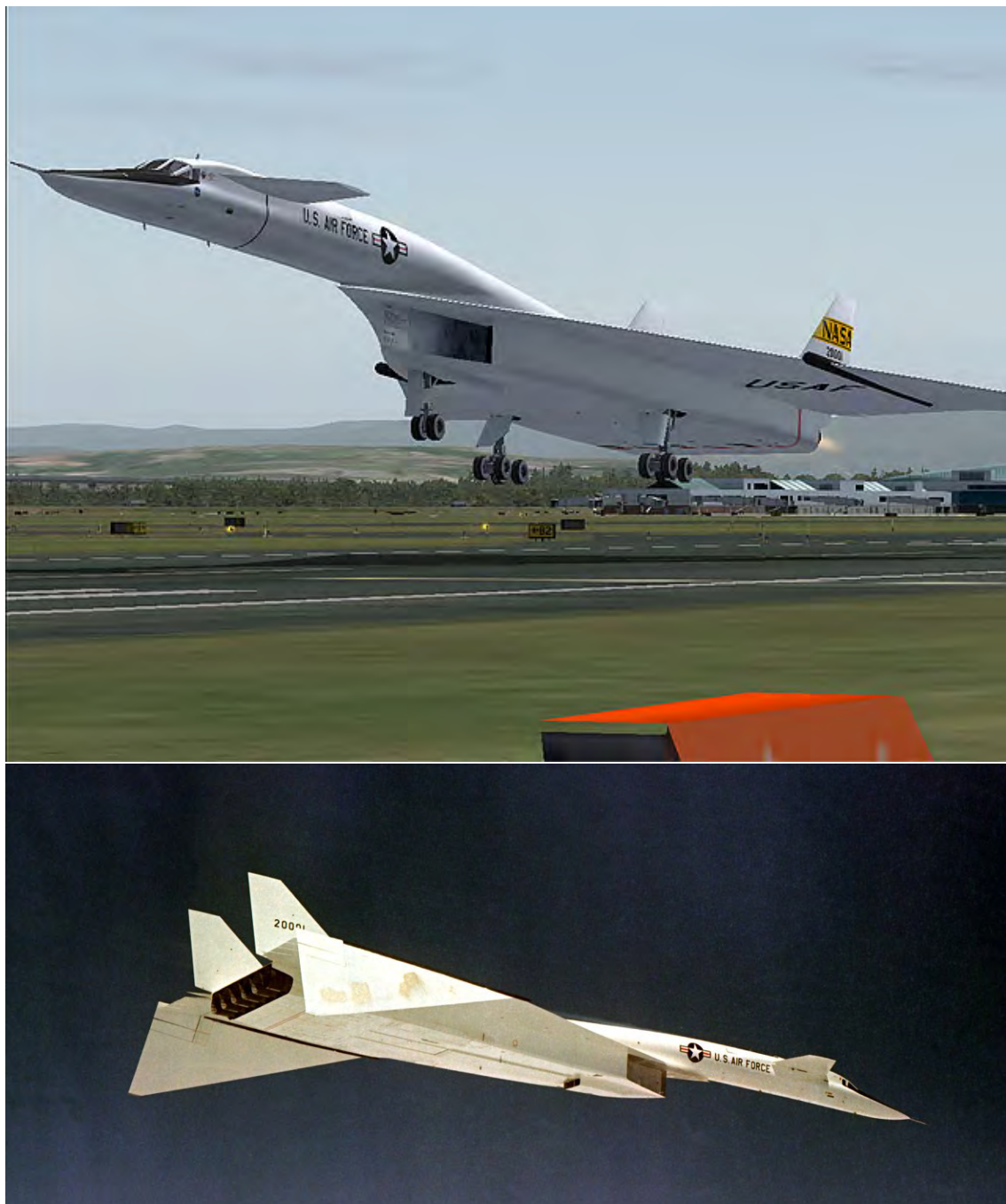
Figure 7.9: Compensazione dello spostamento del centro di pressione nel North American Aviation XB-70, da [144, 145].
