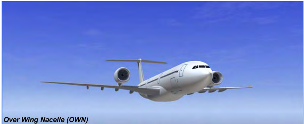
Figure 1.16: Configurazione Over the Wing Nacelle (OWN), da [6].
