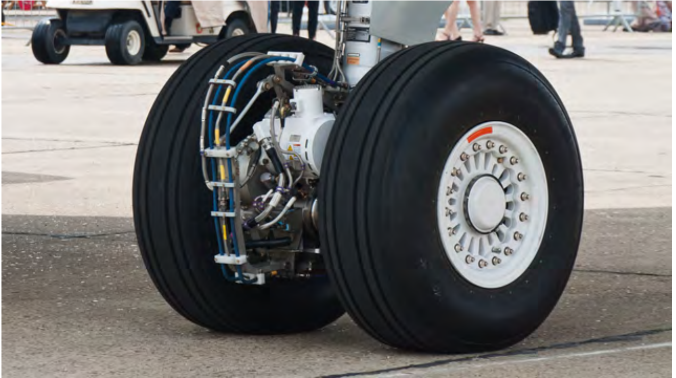
Figure 1.14: Carrello azionato da motore elettrico, da [26].
