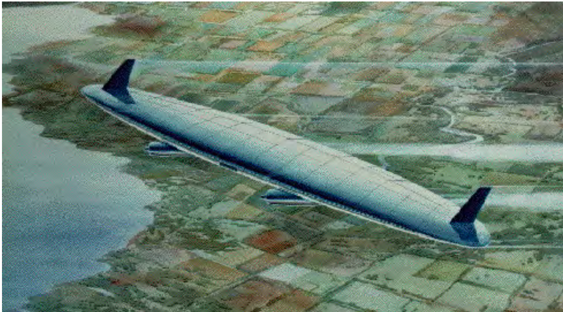
Figure 8.7: Configurazione ad ala di Prandtl, da [149].
