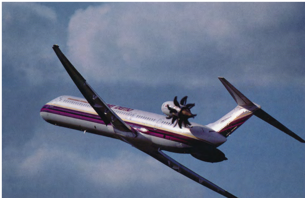
Figure 6.30: Aereo sperimentale con motore propfan ubicato in coda, da [135].
