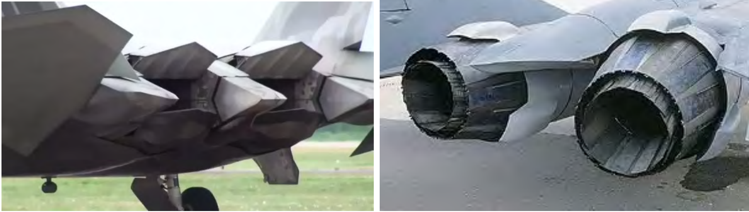
Figure 11.13: Ugelli orientabili dello (a sinistra) F-22 Raptor, e del (a destra) MiG-29, da [68].
