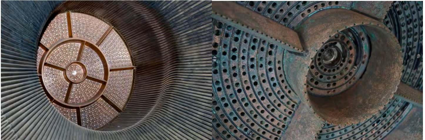
Figure 18.10: Piastra d'iniezione di un motore F-1 del lanciatore Saturn V, (sinistra) prima e (destra) dopo l'uso, da [128, 129].
