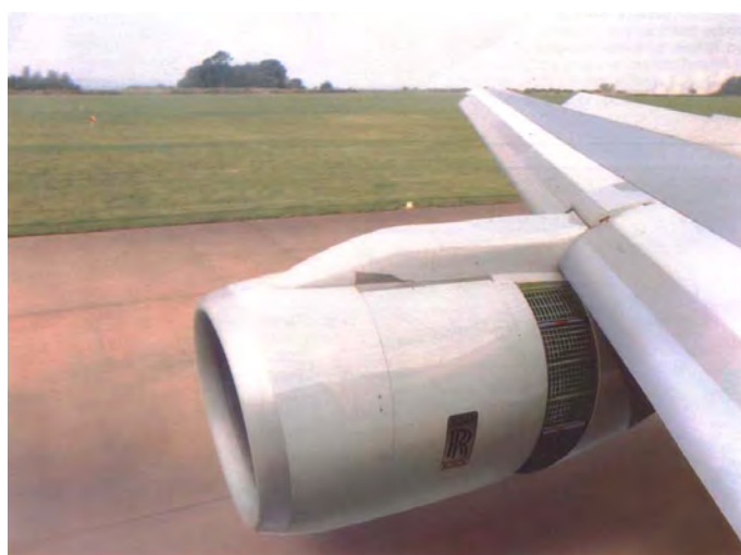
Figure 11.9: Feritoie per la fuoriscita del flusso freddo, da [44].
