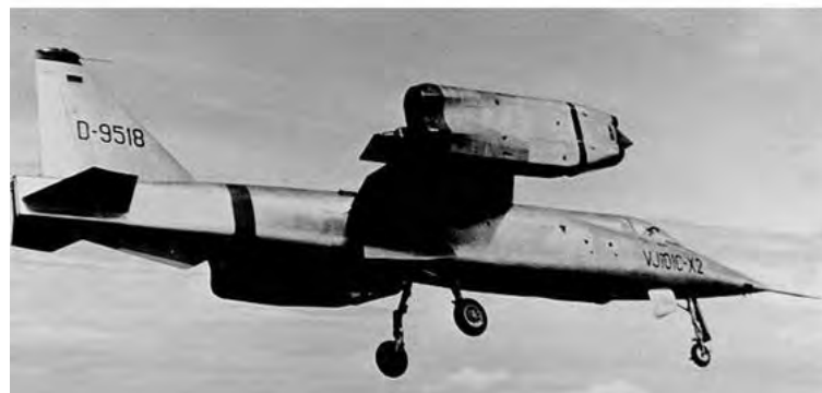
Figure 11.11: Aereo con motori orientabili EWR VJ 101, da [66].
