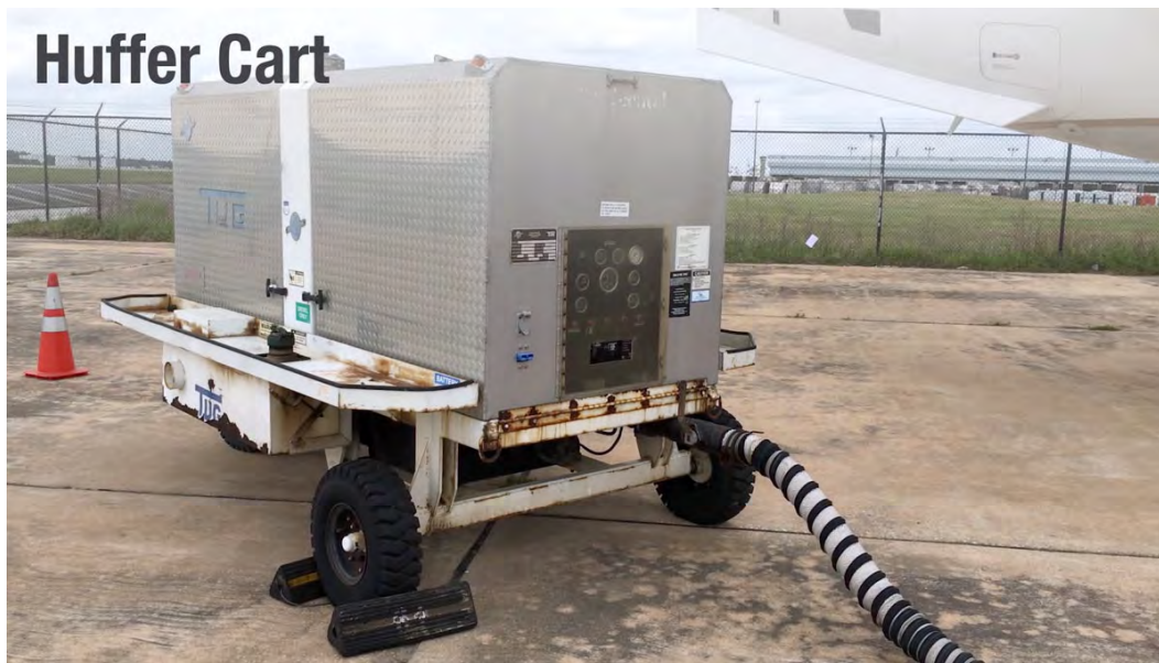
Figure 7.21: Unità di avviamento ad aria, da [46]
