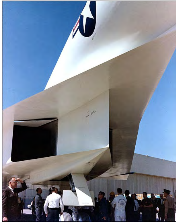
Figure 10.14: Prese d'aria rettangolari dei motori del North American XB-70; si può intravedere la rampa mobile (in alto), da [62].
