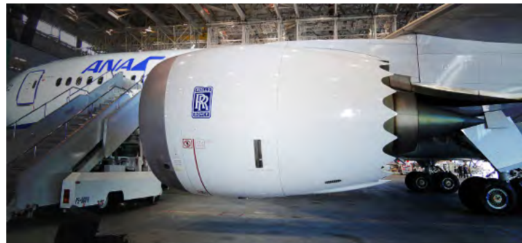
Figure 11.14: Ugello chevron del Boeing 787, da [69].
