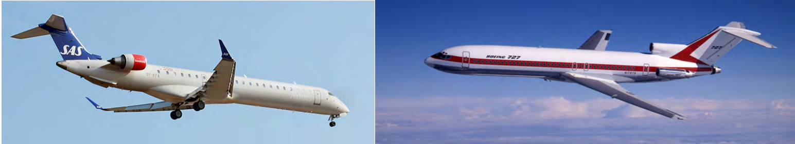
Figure 14.12: Aerei con motori in coda e timone a T: (sinistra) Bombardier CRJ900, (destra) Boeing 727, da [92, 93].
