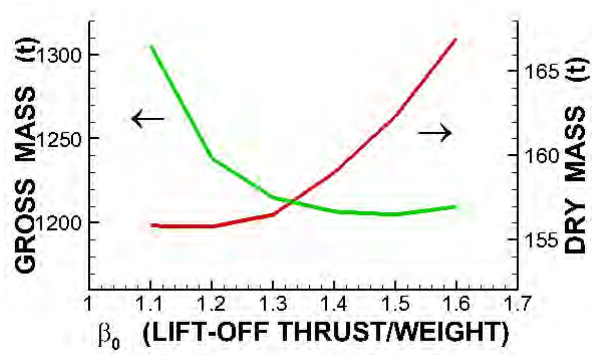
Figure 16.12: Andamento della massa al decollo del lanciatore (a sinistra) e della massa dry (a destra) in funzione del rapporto spinta peso/ del lanciatore al decollo.
