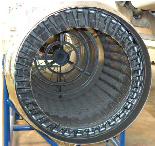
Figure 8.4: Sezione trasversale di un turbogetto con postbruciatore, dalla quale possibile vedere la configurazione dei flameholders .
