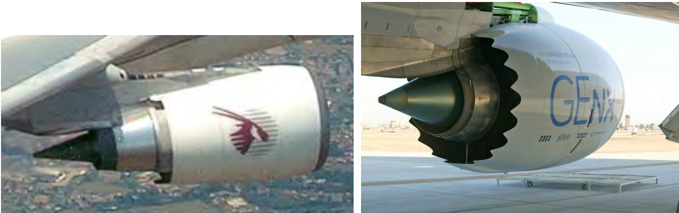
Figure 11.3: Ugelli a spina conica, da [64].
