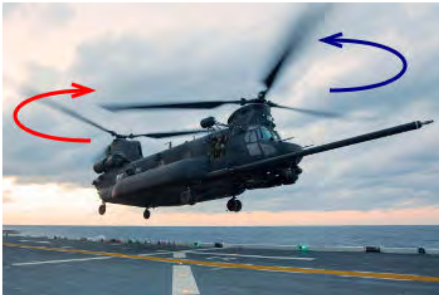
Figure 5.21: Elicottero con rotori in tandem controrotanti, da [30].
