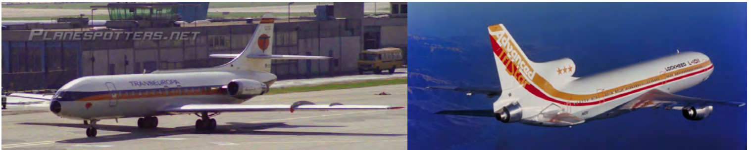
Figure 14.13: Aerei con motori in coda, senza timone a T: (sinistra) Sud Aviation Caravelle, (destra) Lockheed L-1011, da [94, 95].
