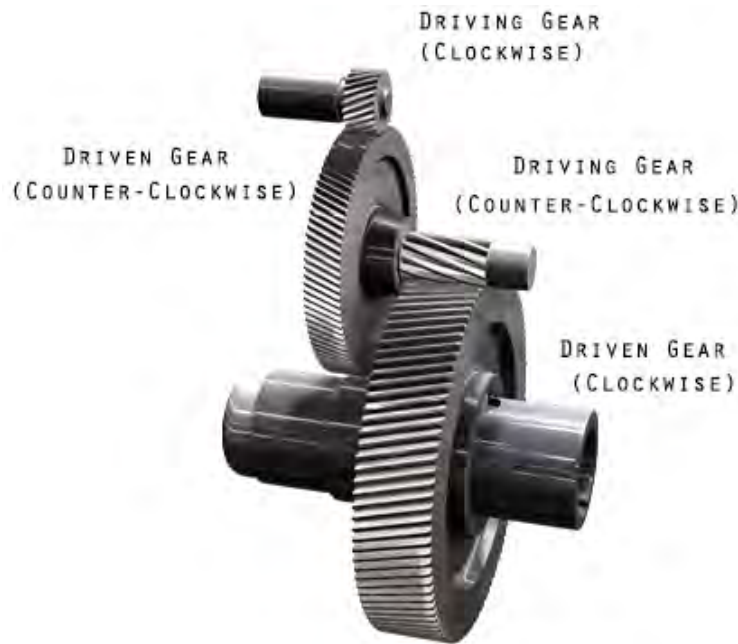
Figure 5.16: Riduttore a ruote dentate, da [28].
