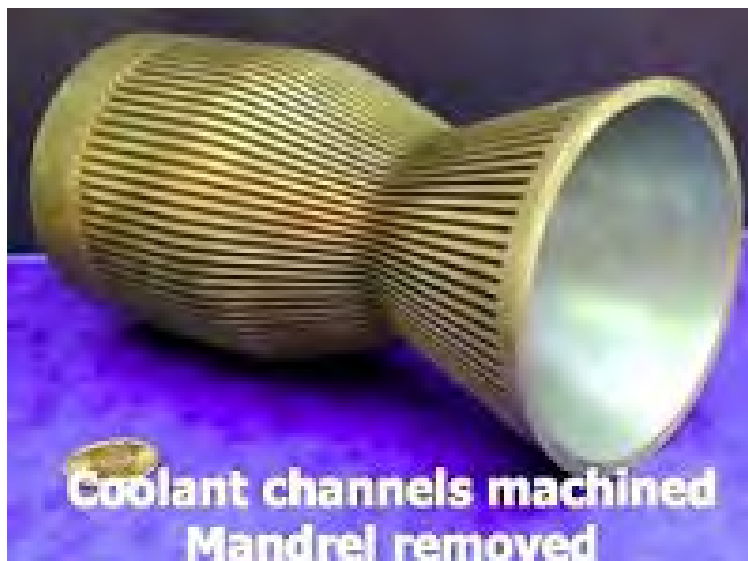
Figure 18.16: Canali di refrigerazione scavati entro le pareti della camera di spinta.
