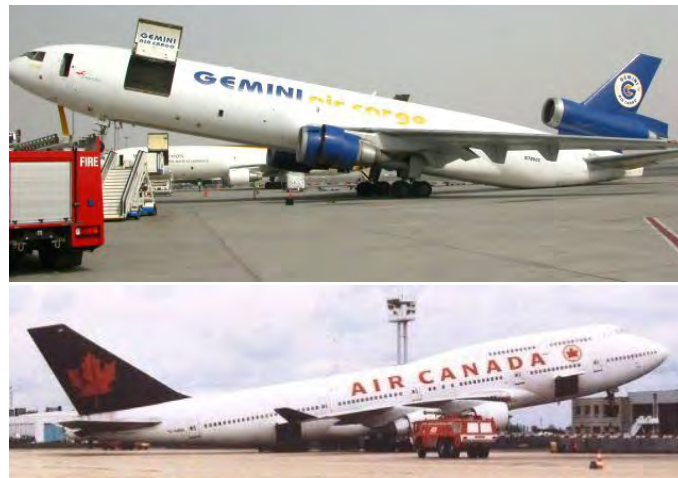
Figure 14.11: Ribaltamento di un DC-10 (trimotore), e di un Boeing 747, dovuto a cattiva gestione del carico, da [90, 91].
