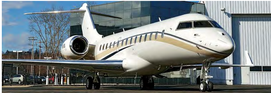
Figure 14.10: Bombardier Global Express (fino a 19 passeggeri) con motori in coda; si noti la limitata altezza delle ali da terra, da [135].
