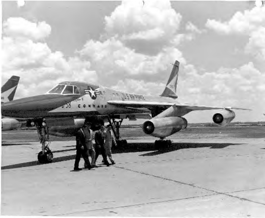
Figure 10.13: Prese d'aria assialsimmetriche dei motori del Convair B-58, da [61].
