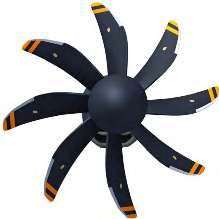
Figure 5.8: Elica di un propfan, da [33].
