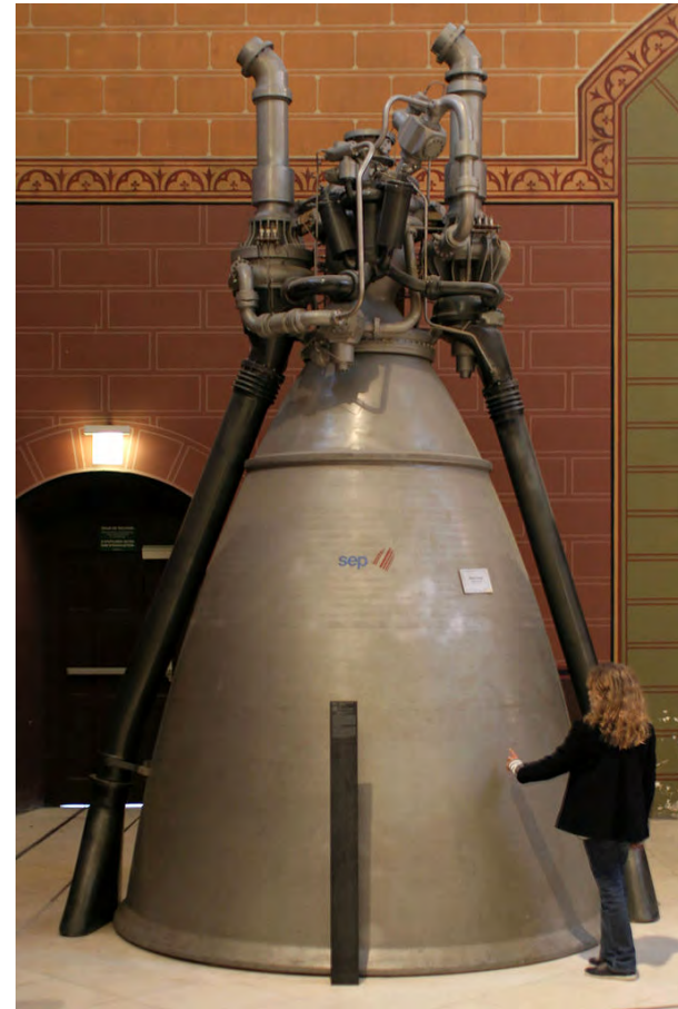
Figure 18.24: Schema di sistema a turbopompe con ciclo a generatore di gas (in questo caso si è assunto che i prodotti del generatore di gas siano re-iniettati nell'ugello), ed esempio applicativo (motore Vulcain Mk1, in cui i prodotti dei due generatori defluiscono da ugelli separati).
