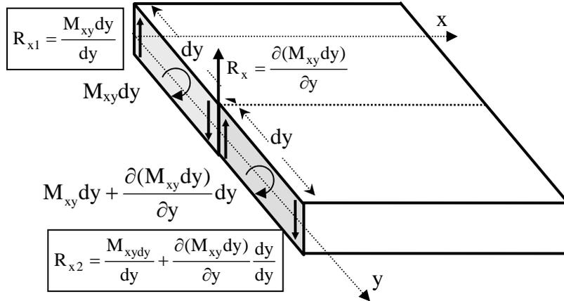
Il momento  $M_{xy}dy$  sul tratto  $dy$  può essere pensato come dovuto a due forze di intensità  $R_{x1}=(M_{xy}dy)/dy$  a distanza  $dy$ ; analogamente il momento sul secondo tratto è dato da due forze  $R_{x2}=(M_{xy}dy)/dy+\partial(M_{xy}dy)/\partial y$ . Nell'unione dei due elementi queste forze si compensano, salvo che per il loro incremento che diviso per  $dy$  dà una forza di taglio per unità di lunghezza  $Q_x$ :
