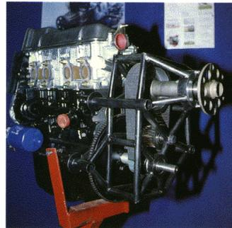
tubi in acciaio 4130 saldati a TIG. La cinghia, prodotta dalla Daico su specifica JEOF, è larga soli 45 mm e consente una potenza continua di 100 cavalli. Il nuovo riduttore equipaggerà di serie sia il Sax 75 (da 70 cavalli) sia il Sax 86. Altra novità, la super-affidabile accensione quadrupla a controllo elettronico con quattro bobine, che riduce al massimo i cablaggi in alta tensione.
