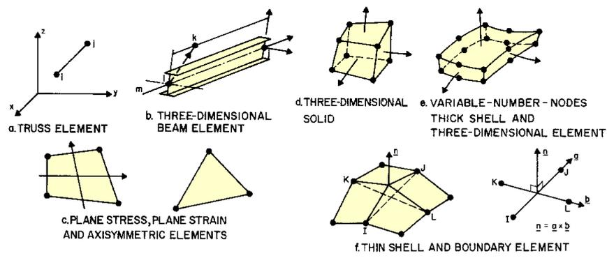
a. TRUSS ELEMENT      b. THREE-DIMENSIONAL BEAM ELEMENT      d. THREE-DIMENSIONAL SOLID      e. VARIABLE-NUMBER-NODES THICK SHELL AND THREE-DIMENSIONAL ELEMENT
