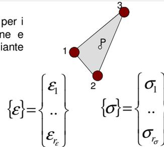
dimensionalmente:  $[B] [r_\varepsilon \ x \ ml]$  Matrice di deformazione
