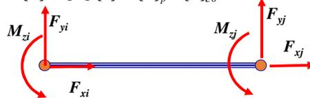
Trascurando l'effetto del taglio, lecito per travi snelle, ai nodi si avrà uno stato di tensione e deformazione monoassiale indotto dalla sovrapposizione degli effetti normali e flessionali. I due punti critici coincidono con la fibra tesa e compressa delle sezioni ai nodi, e si avrà:
