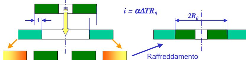
Dilatazione per riscaldamento del disco esterno
