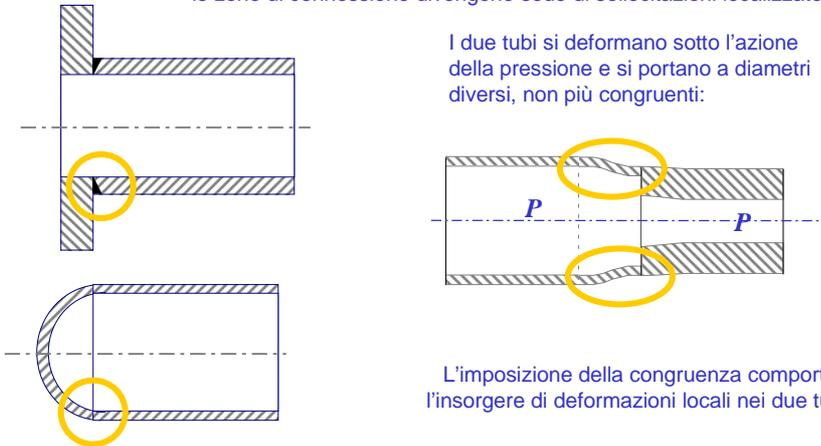
I due tubi si deformano sotto l'azione della pressione e si portano a diametri diversi, non più congruenti:
