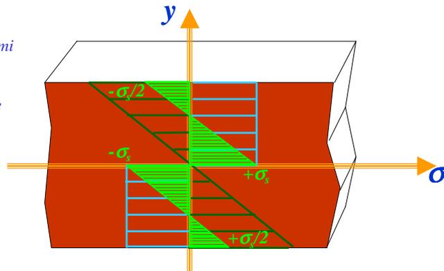
Il sistema di tensioni residue ottenute può essere utilmente sfruttato per modificare la capacità di carico della trave: infatti, per portare nuovamente la sezione considerata ad incipiente plasticizzazione è ora necessario applicare un momento pari a  $+1.5 M_e$ .
