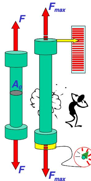
Determinazione delle prestazioni del materiale: la prova di trazione
