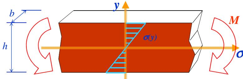
Nel caso di comportamento elastico del materiale, l'andamento  $\sigma(y)$  delle tensioni nella sezione ha l'espressione trovata in precedenza:  $\sigma(y) = \frac{\sigma_{\max}}{h/2} y$
