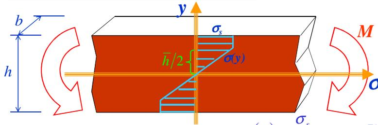
Nel caso di comportamento del materiale elastico-plastico perfetto, l'andamento  $\sigma(y)$  delle tensioni nella sezione ha l'espressione:
