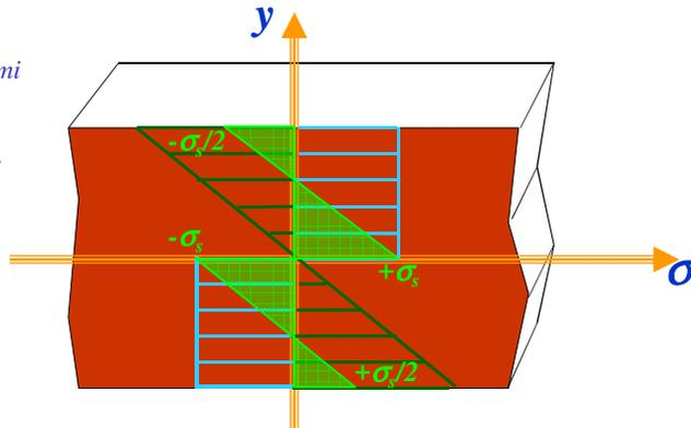
Il sistema di tensioni residue ottenute può essere utilmente sfruttato per modificare le capacità di carico della trave: infatti, per portare nuovamente la sezione considerata ad incipiente plasticizzazione è ora necessario applicare un momento pari a  $+1.5 M_e$ .
