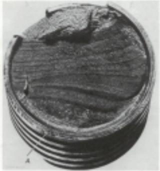
Rottura di un tirante con filettatura a sezione rettangolare. La rottura ha avuto innesco nella zona indicata con A
