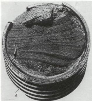
Rottura di un tirante con filettatura a sezione rettangolare. La rottura ha avuto innesco nella zona indicata con A
