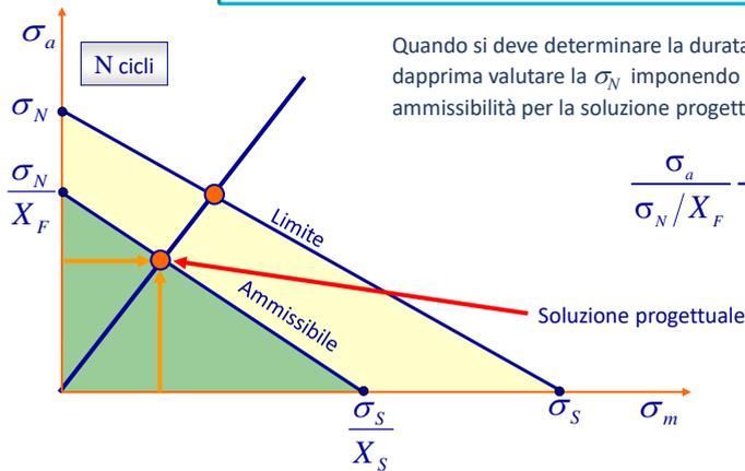
Quando si deve determinare la durata  $N$  di un componente si dovrà dapprima valutare la  $\sigma_N$  imponendo il passaggio del confine di ammissibilità per la soluzione progettuale ( $\sigma_a, \sigma_m$ ):
