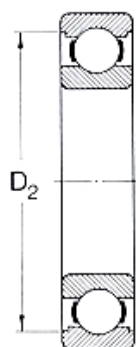
Spalleggiamenti dell'anello esterno con scanalatura
