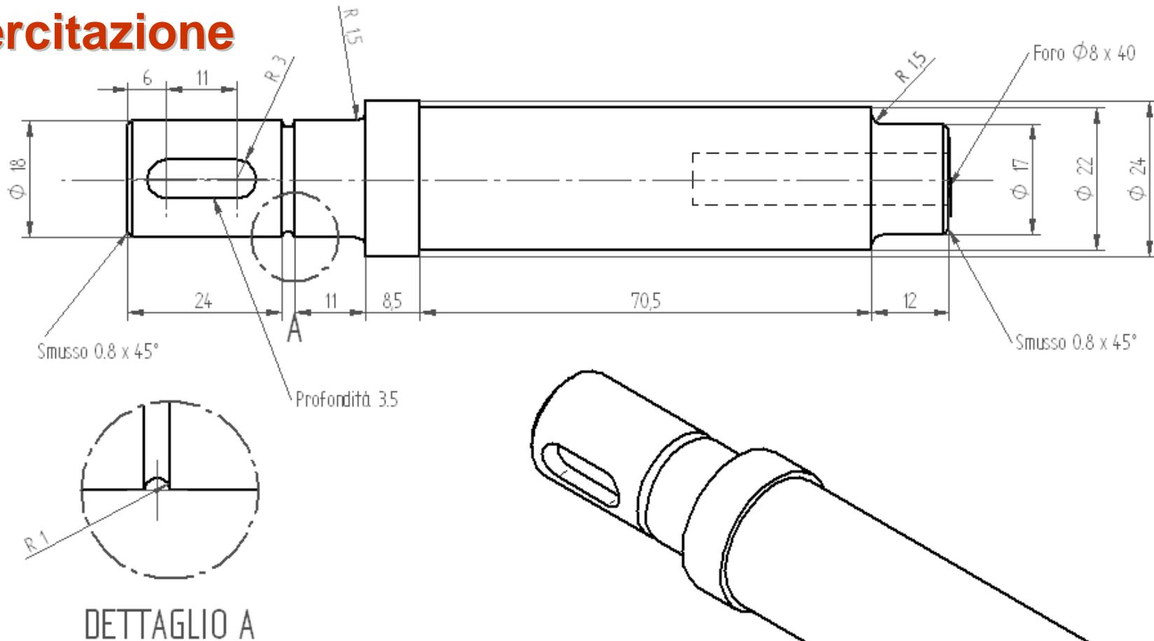
Realizzare il **modello solido** del componente utilizzando le feature **protrusione** e **scavo di rivoluzione** quando possibile.
