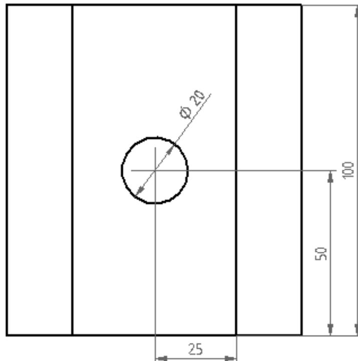
Realizzare il **modello solido** del componente imponendo i **vincoli geometrici** e **dimensionali** sulla base delle proiezioni ortogonali riportate in figura.
