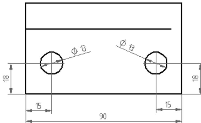
Realizzare il **modello solido** del componente a partire dalle proiezioni ortogonali rappresentate in figura. Avvalersi di **vincoli geometrici** e **dimensionali** per la quotatura dei profili.
