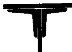
Fig. 2.53 - Le sezioni d'assieme di piccolo spessore si evidenziano lasciando una spaziatura bianca tra elementi adiacenti.
