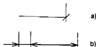
Fig. 2.97 - a) Le frecce possono essere sostituite da brevi tratti inclinati a 45^\circ rispetto alla linea di misura. b) Di norma le frecce sono disposte all'interno delle linee di riferimento salvo nei casi di mancanza di spazio: allora esse possono essere disposte all'esterno.
