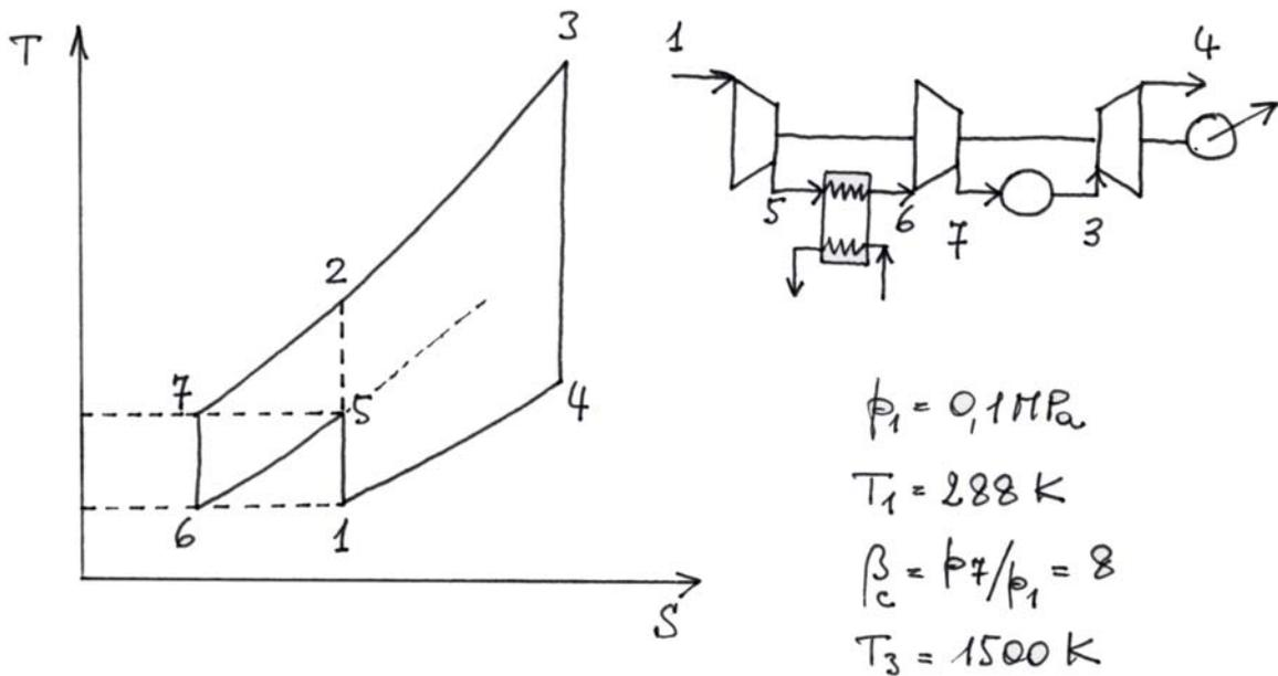
Interrefrigerazione uniforme :  $T_6 = T_1 = 288 \text{ K}$
