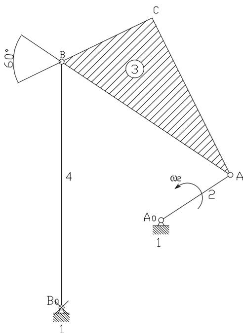
Nella configurazione che il meccanismo assume dopo un tempo  $t = 0.1 \text{ s}$ , valutato a partire dall'istante in cui la manovella è sovrapposta al semiasse  $x$  positivo, si determinino:
